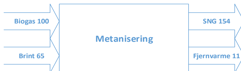
Figur 15: Energistrømme ved metanisering af biogas.
