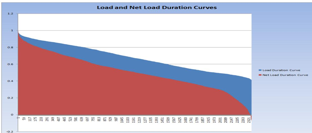
Figure 4.3: Load and Net Load Duration Curves in West DK, Sep. 2009-Jan. 2010
