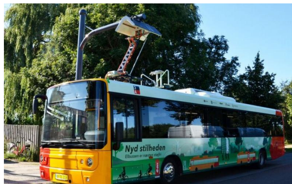
Figur 1: Forsøgselbussen på linje 3A under hurtigopladning med pantograf. [ https://www.kk.dk/nyheder/fremtidens-el-busser-koerer-nu-i-koebenhavn ]
