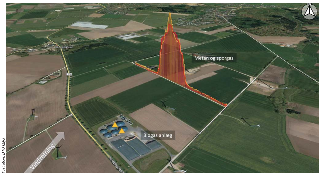
Figur 2. Eksempel på sporgasmåling til bestemmelse af metantab. Højden af den røde kurve er proportional med målte koncentrationer af metan over baggrundsniveau, mens højden af den gule kurve er proportional med koncentration af sporgas. De gule trekanter viser, hvor der blev frigivet sporgas.
