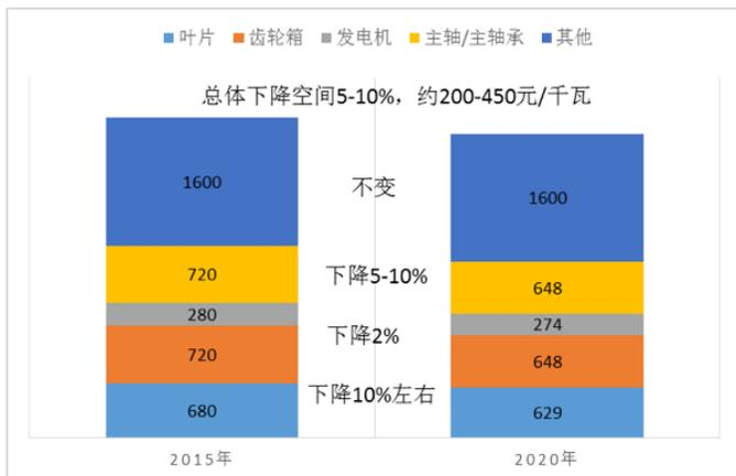
图 13-6 “十三五”期间 2 兆瓦风电机组单位千瓦成本变化预期 (元/千瓦)
