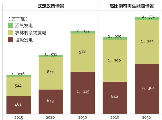
图 7-21 两种情景下生物质发电装机发展情况
